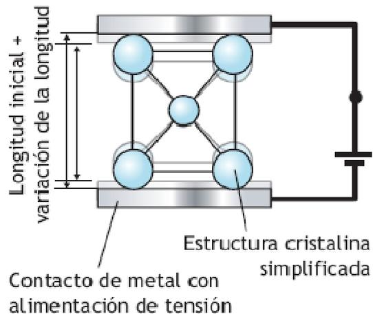
**8.43.** Variación de la longitud de un elemento piezoeléctrico.
