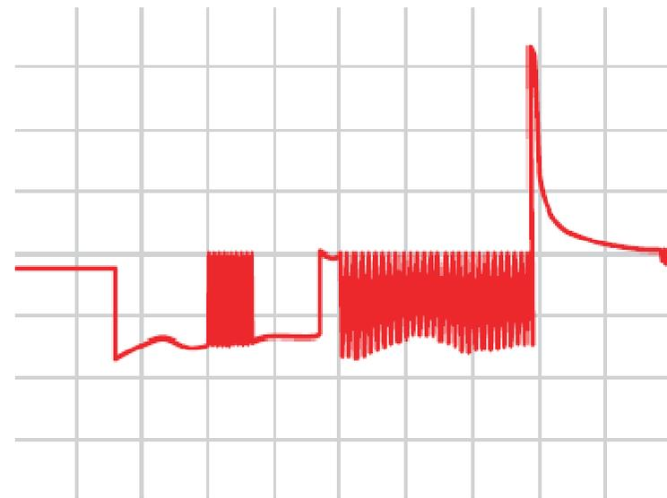
8.40. Señal de un inyector-bomba a ralentí.
