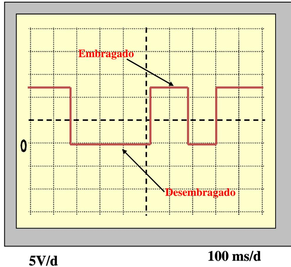
Conexión osciloscopio: **66 y masa**
