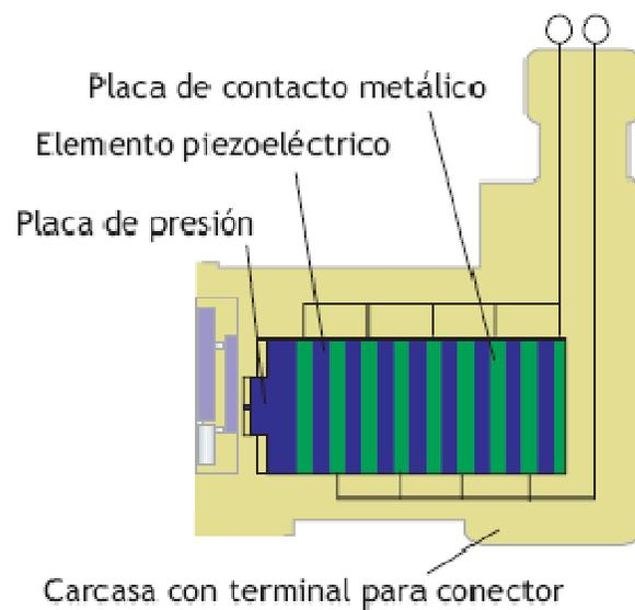
8.45. Esquema de un actuador piezoeléctrico.
