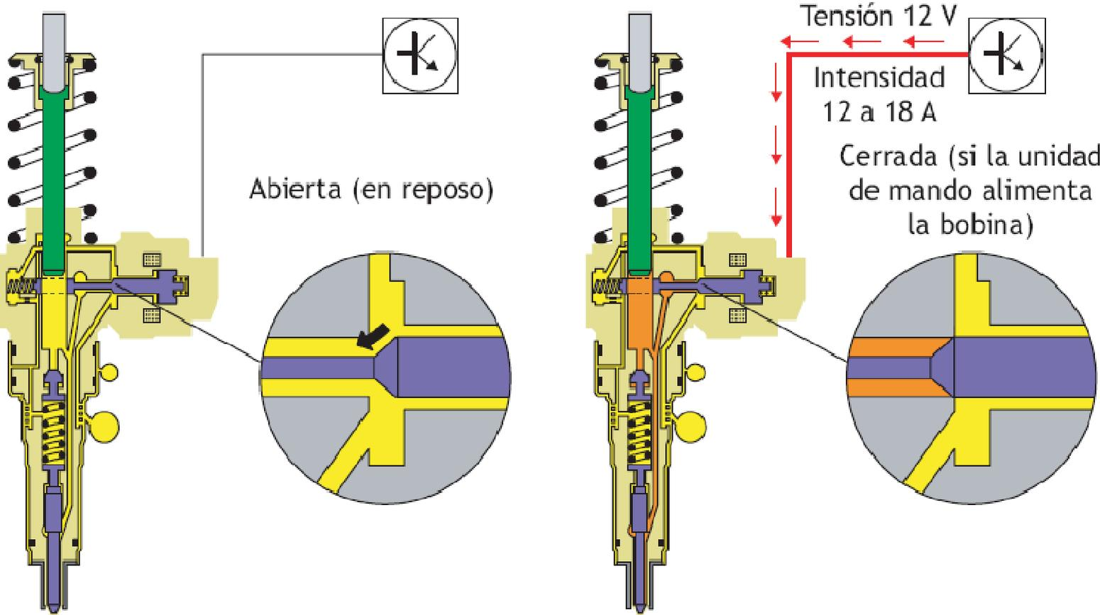
8.38. Posiciones de la aguja del inyector-bomba en función de la intensidad recibida.
