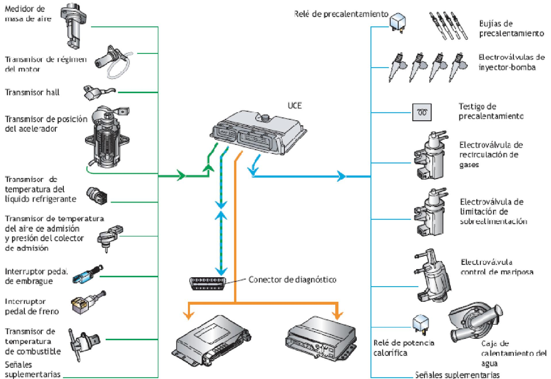
8.24. Representación esquemática de un sistema EDC con sistema inyectorbomba.
