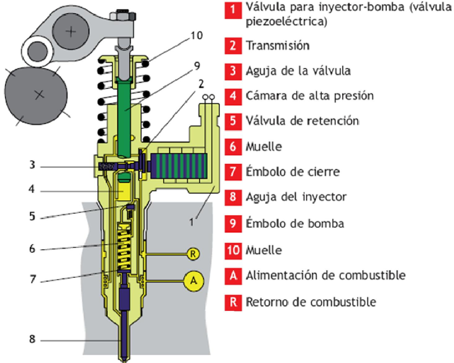
8.42. Estructura de un inyector piezoeléctrico.
