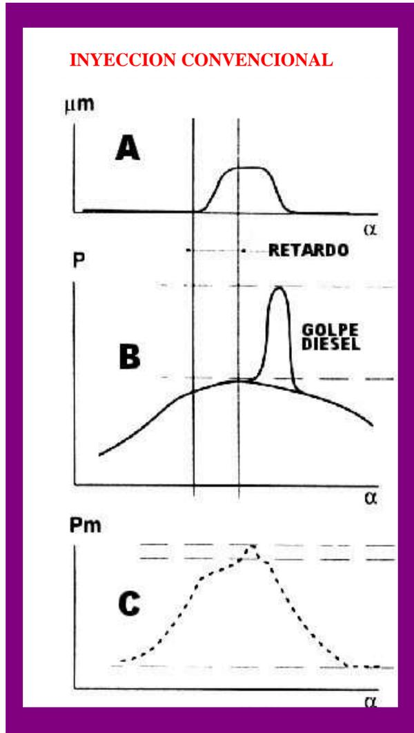
• Para que el combustible se queme de forma eficaz, la mezcla debe ser la adecuada. Si no se inyecta el combustible en el **momento** adecuado y en la **cantidad** precisa, sucede lo siguiente:
