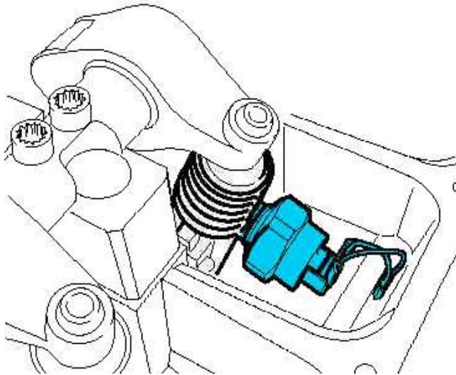
Son válvulas electromagnéticas gestionadas por la unidad de control del motor.
