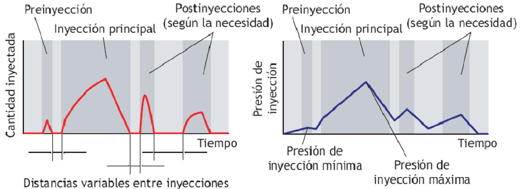
La presión máxima puede alcanzar los 2200 bar, frente a los 2050 bar
