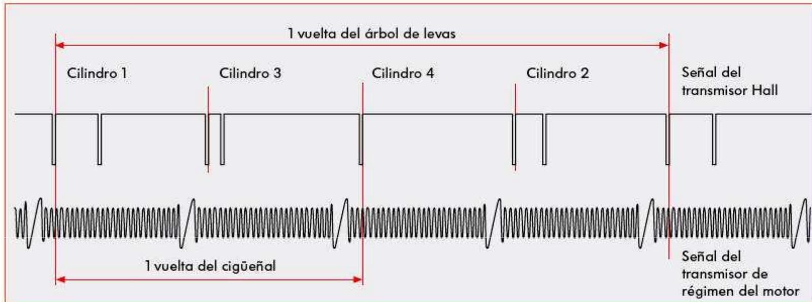
Para lograr un arranque rápido, la unidad de control del motor analiza las señales procedentes del transmisor Hall y del transmisor de régimen del motor.
