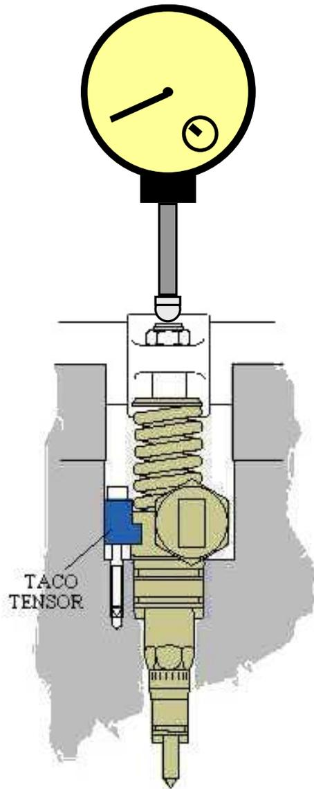
Ajustar correctamente el inyector-bomba para evitar que el embolo golpee contra el fondo de la cámara de alta presión, para ello:
